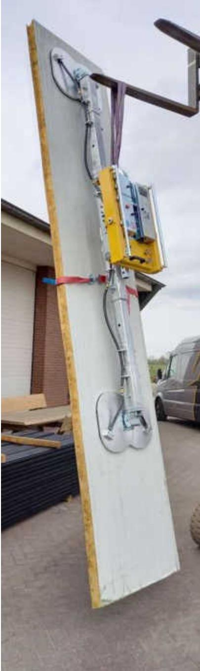
Befestigung der weiß-roten Fallsicherung am zentralen Verlängerungsrohr.
