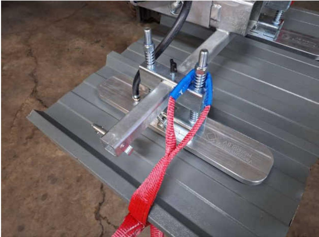
Auf dem ersten Foto unten werden beide Schlaufen (1) an jedem Ende der roten Sicherheitschlinge verwendet. Auf diese Weise ist die rote Sicherheitschlinge zu lang, so dass sie zu locker um das Dachblech hängt (siehe Pfeil). Es ist nicht sicher, auf diese Weise zu arbeiten:
