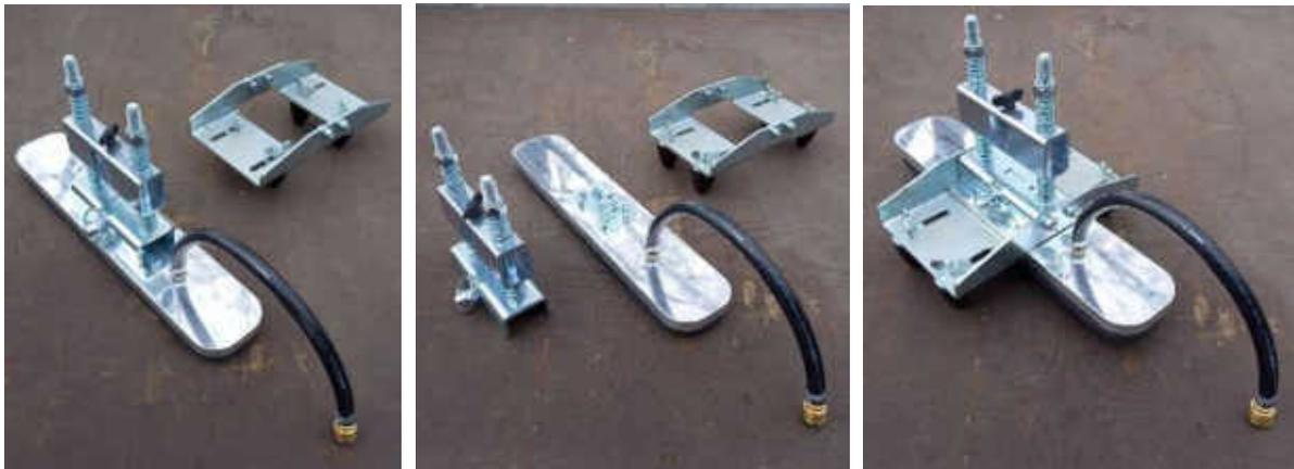
Stellen Sie die Maschine zunächst mit den schwarzen Suchern nach außen passgenau auf die Dachplatte (linkes Foto). Lassen Sie dann die Saugnäpfe an der Dachplatte saugen. Wenn die Saugnäpfe perfekt ausgerichtet und an der Dachplatte befestigt sind, können Sie die schwarzen Sucher hineinschieben (rechtes Foto), bis sie die Dachplatte berühren. Jetzt sind die Sucher ausgerichtet und Sie können sie mit den Rändelschrauben festziehen.
