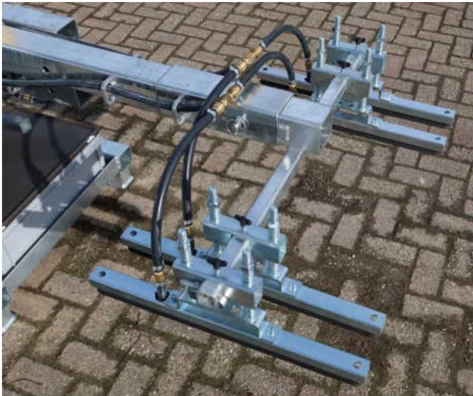
Mit dem Dach- und Wand Set können Dachpaneele angehoben werden. Um die Sicherheit gemäß NEN-EN 13155 zu gewährleisten, ist die rote Absturzsicherung nicht erforderlich.
