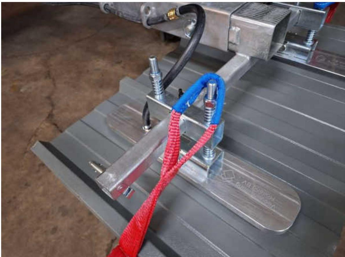
Auf diesem Foto ist die Schlaufe der roten Sicherheitsschlinge richtig um den Bolzen der flexiblen Aufhängung gelegt. Jetzt ist ein sicheres Arbeiten möglich:
