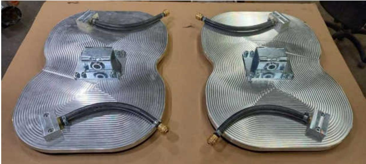
Mit 2 Saugnapfen können auch schmal geschnittene Plattenstücke angehoben werden. Von den 4 verfügbaren Schnellkupplungen der Maschine müssen dann 2 mit den mitgelieferten Stopfen verschlossen werden. Verwenden Sie immer den weiß-roten Fallschutz, um weiterhin die Sicherheitsnorm NEN-EN 13155 einzuhalten. Das maximale Gewicht (WLL) ist somit auf 180 kg begrenzt.
