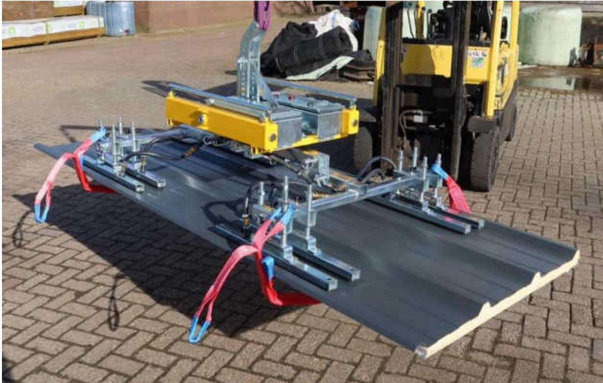
Stellen Sie die Breitenpositionen der Saugnäpfe immer symmetrisch ein. Sichern Sie diese mit den Flügelschrauben, die sich an jeder flexiblen Aufhängung befinden (siehe Foto oben). Prüfen Sie, ob die Sicherungsstifte (siehe Foto unten) an beiden Enden der Traverse vorhanden sind.
