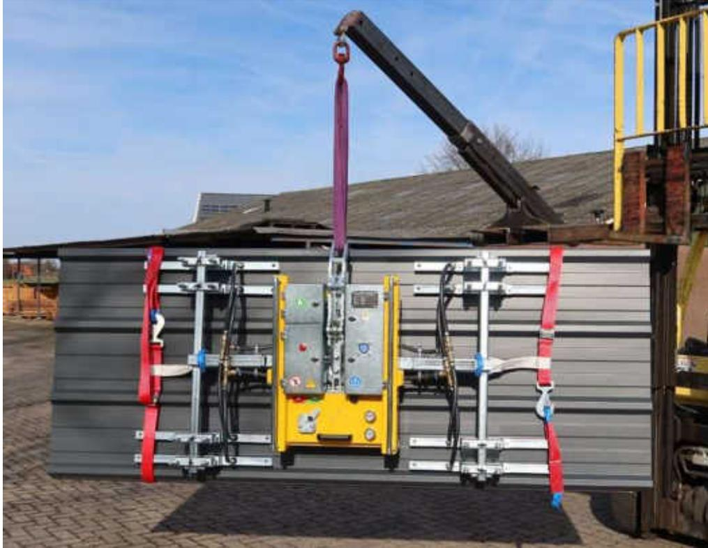
In dieser Konfiguration werden die Schlaufen der weißen Bänder um die Endquerträger gewickelt. Es werden keine Stifte und Wellensicherungsstifte benötigt.
