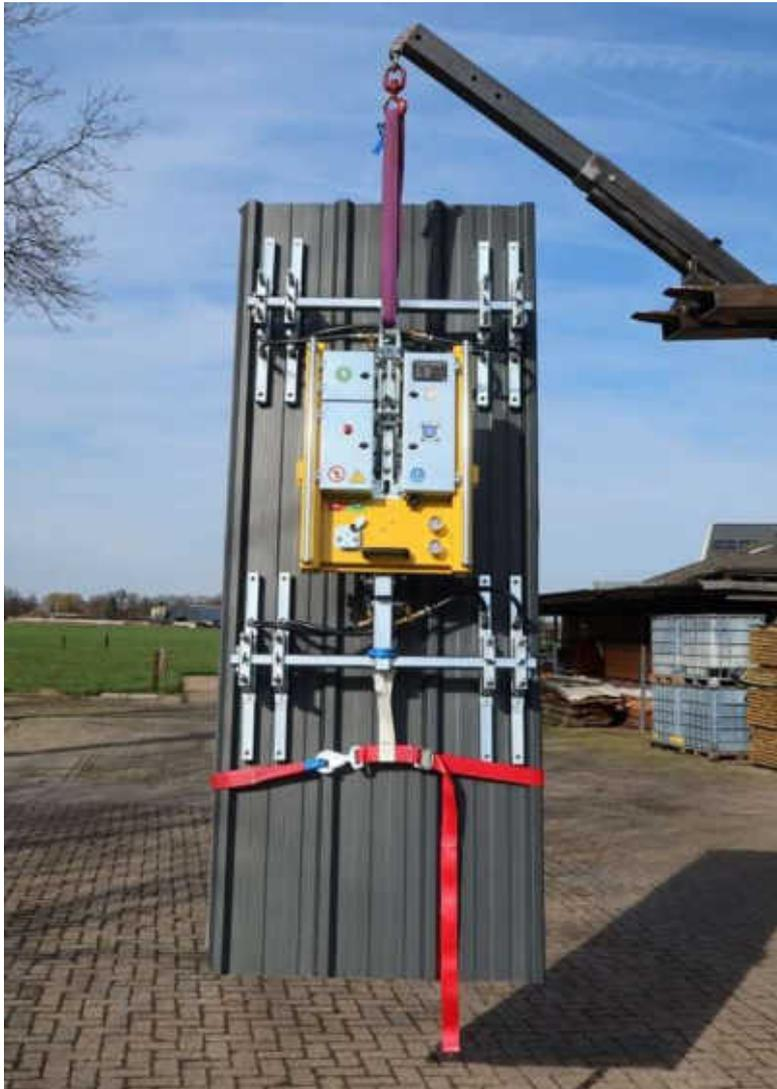
In dieser Konfiguration wird die Schlaufe des weißen Riemens um den Endquerträger gewickelt. Es werden keine Stifte und Wellensicherungsstifte benötigt.
