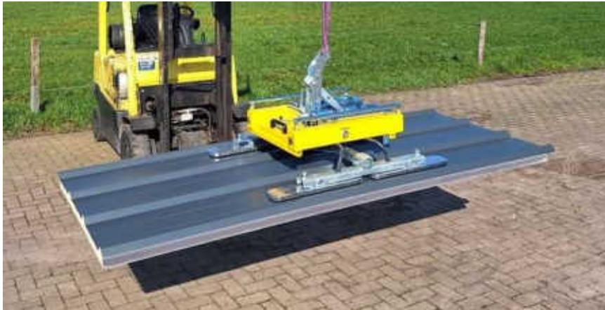
Positionieren Sie die Maschine über der Mitte der vertikalen Wandplatte.
