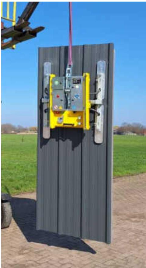
Positionieren Sie die Maschine in der Mitte der horizontalen Wandplatte. Positionieren Sie die Maschine nach Möglichkeit höher auf der Platte, dann lässt sich die Platte leichter neigen.
