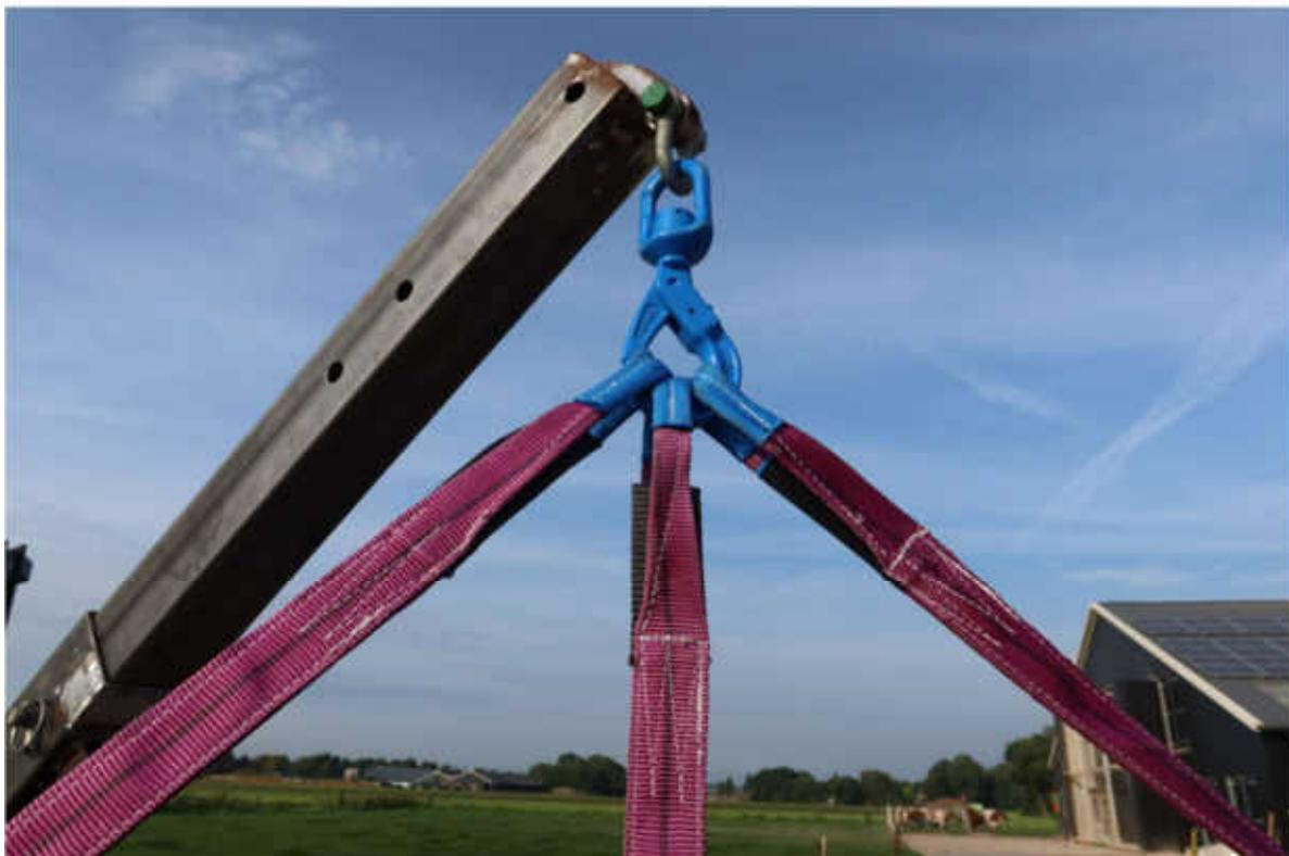
Diese Konfiguration ermöglicht das Anheben von Dachplatten. Um die Sicherheit gemäß NEN-EN 13155 zu gewährleisten, ist die rote Absturzsicherung erforderlich.
